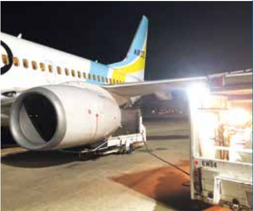
エンジン洗浄中の様子
